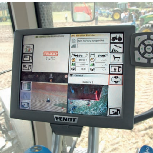
Auf der Vorführung wurde auch die Online-Übertragung der Auftrags- und Arbeitsdaten demonstriert. Die Grimme Kartoffellegemaschine wurde vom Fendt Traktor gezogen, wobei die Steuerung ausschließlich über das Fendt-Traktor-Terminal erfolgte. Es waren aber auch CCI-Terminals ergänzend zum Traktor- bzw. Häckslerterminals im Einsatz.
