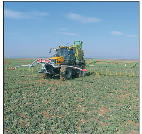
Mithilfe der optisch arbeitenden Sensoren werden Daten über die aktuelle Entwicklung des Pflanzenbestandes erfasst.
