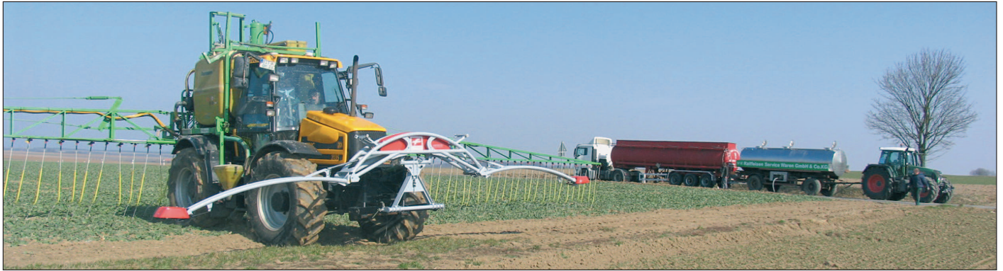
Neben den Schlagkoordinaten werden auch die genauen Auftragsdaten jedes Schlages an die Ausbringfahrzeuge übermittelt. Dadurch wissen die Fahrer sofort, welche Düngermengen auszubringen sind, ob es nasse Stellen auf den Flächen gibt und ob ggf. Hindernisse, wie Grenzsteine oder Strommasten, auftauchen.
