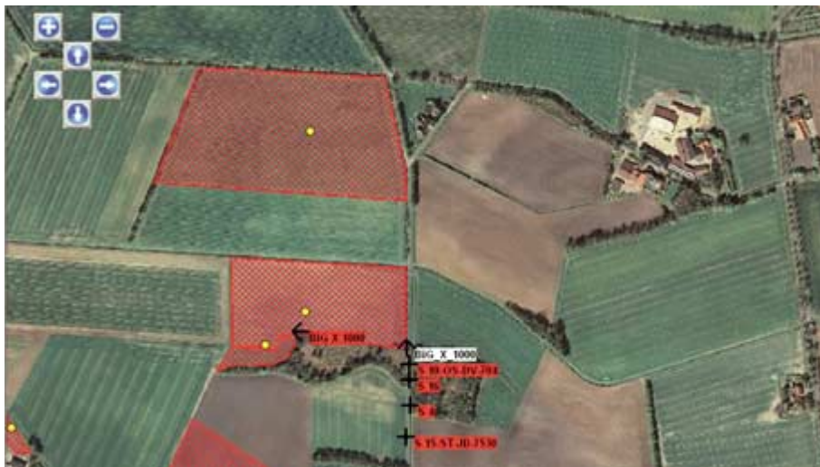
So sieht der Disponent im Büro die Häckselkette. Er sieht Fahrzeuge und Häckler und kann die Fahrzeuge bei Bedarf auch beispielsweise zu einer zweiten Häckselkette umleiten, wenn wie hier Wartezeiten entstehen.
